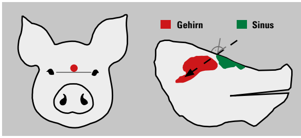
Abb 12: Ansatzpunkt des Bolzenschussapparates bei keilförmiger Kopfform sowie Lage von Gehirn und Stirnhöhle von einem ca. 100kg schweren Schwein
