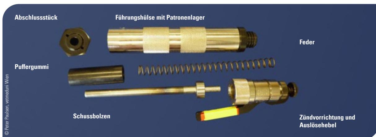
Abb. 4: Für Reinigungszwecke zerlegtes Bolzenschussgerät der Bauart „Blitz“
