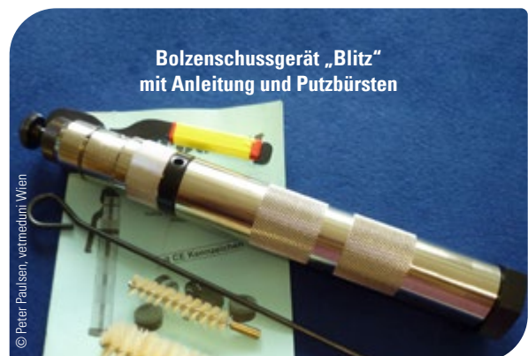
Abb. 6: Bolzenschussgerät Bauart „Blitz“ in ordentlichem Wartungszustand
