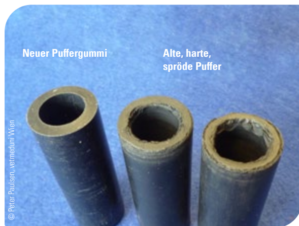
Abb. 10: Alte Gummipuffer müssen ausgetauscht werden
